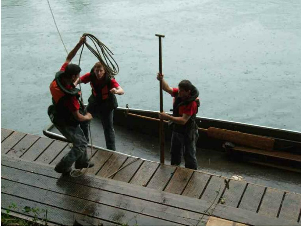
Das Fährseil wird zum Befestigen im Schiff bereitgemacht
